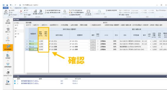
エアフローで入力した設計風量、簡易ダクト抵抗で計算または入力した設計静圧を必要に応じて確認します。
